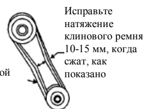
Рисунок 2. Натяжение клинового ремня
